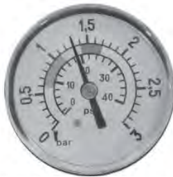
1,3 kg/cm 2 -18,5 PSI : cette pression indique qu'il est nécessaire de procéder au lavage.
