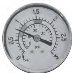
0,8 kg/cm 2 -11,4 PSI : Normaldruck für Filtrationszyklus
