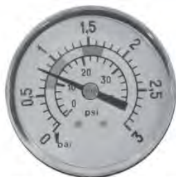
0,8 kg/cm 2 -11,4 PSI : pression normale pour le cycle de filtration.
